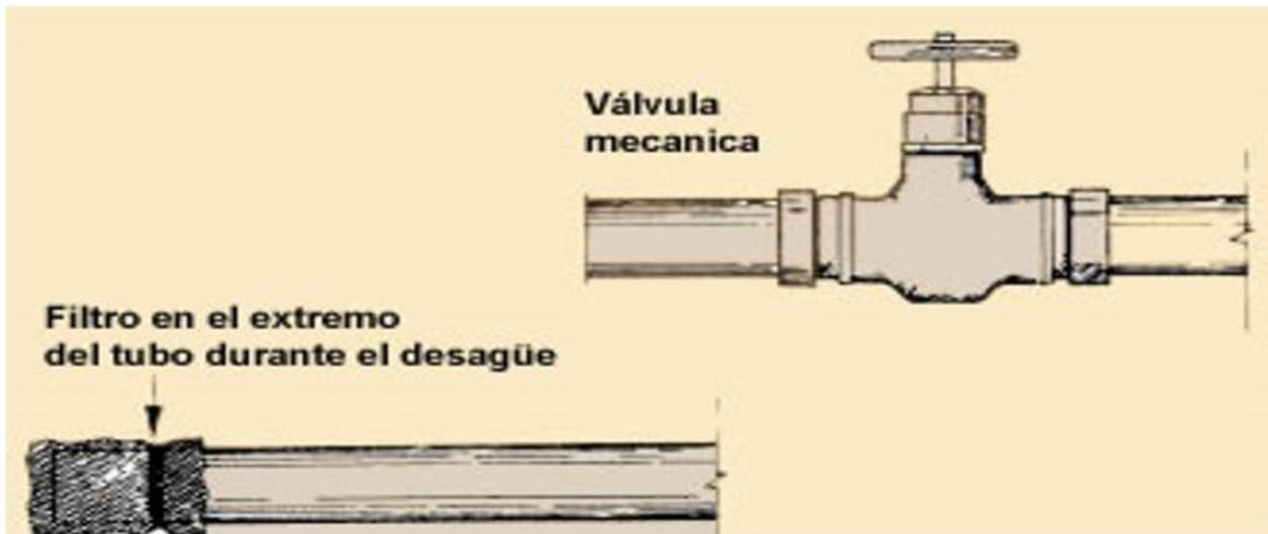
**Llave de paso o válvula:** Llave de control de paso de agua. (Instalaciones para tubos)
